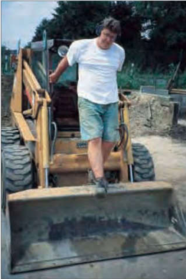
Kompaktlader – Einstieg über die abgesenkte Ladeschaufel
