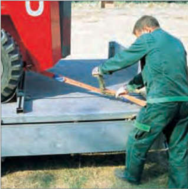
Ladungssicherung mit Zurrmitteln und Keilen
