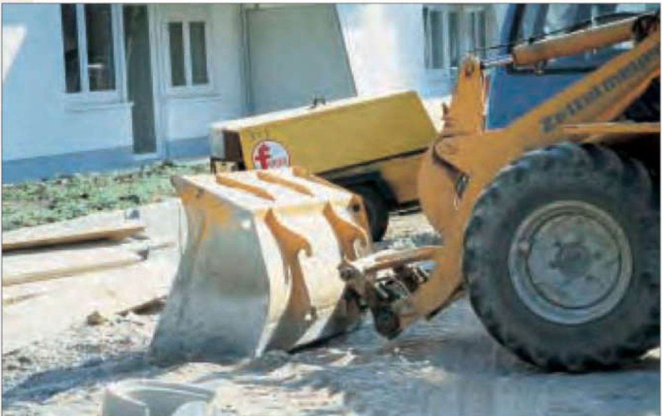
An- und Abbau der Arbeitswerkzeuge durch Schnellwechseleinrichtung
