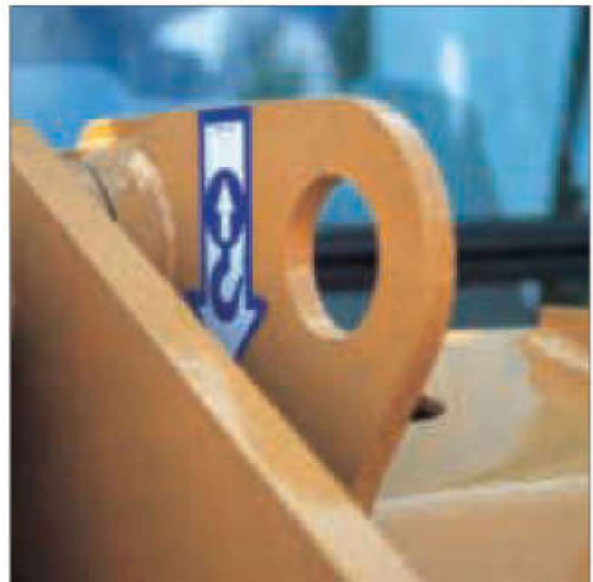
Gekennzeichneter Hebe- und Zurrpunkt am Vorderwagen eines Radladers
