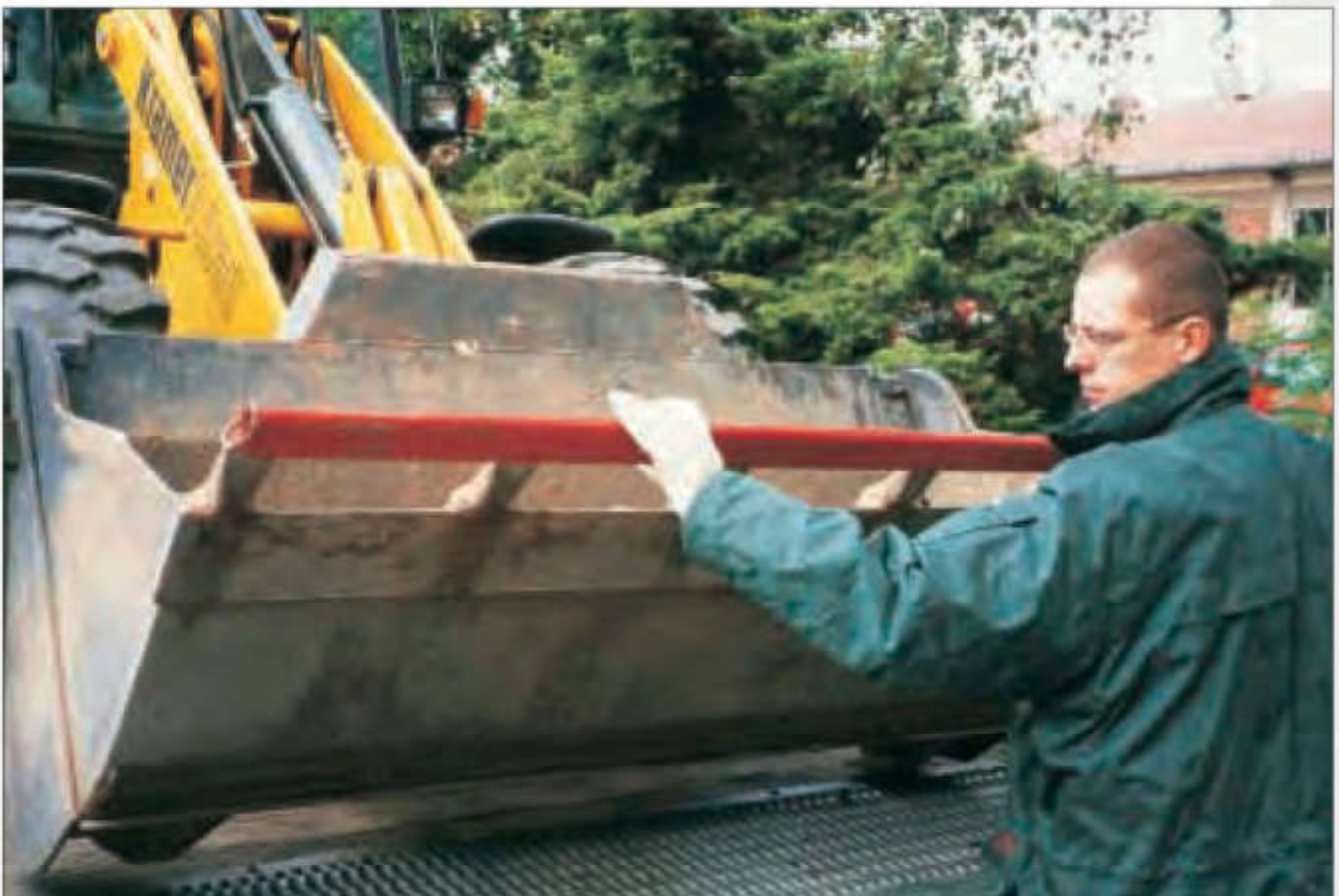
Der Radlader wird für die Straßenfahrt vorbereitet
