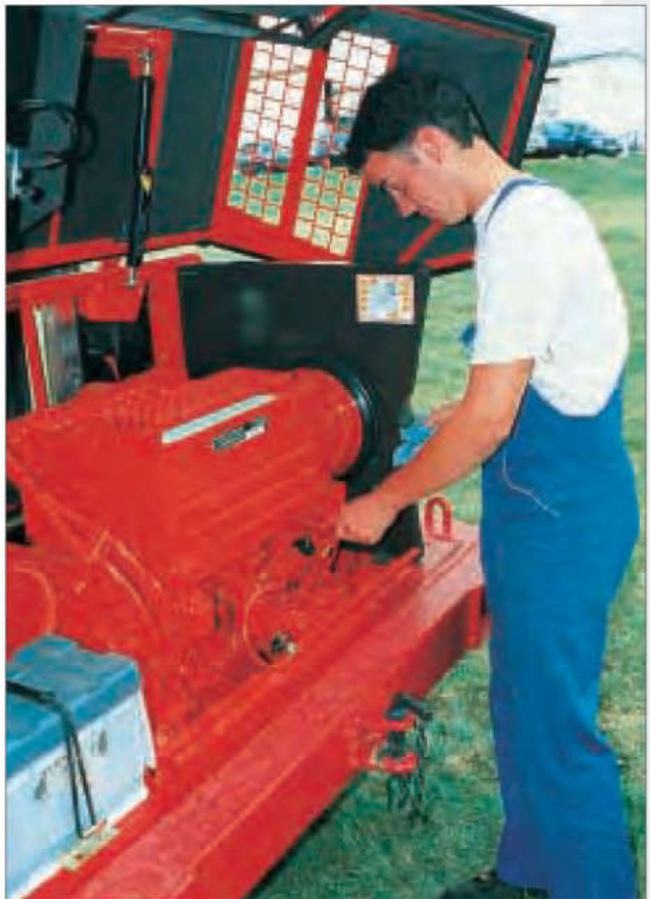
Kontrolle des Motorenölstandes
