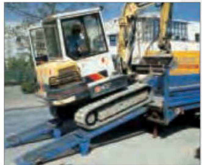
Am Fahrzeug angebrachte abklappbare Auffahrrampe mit Abstützung
