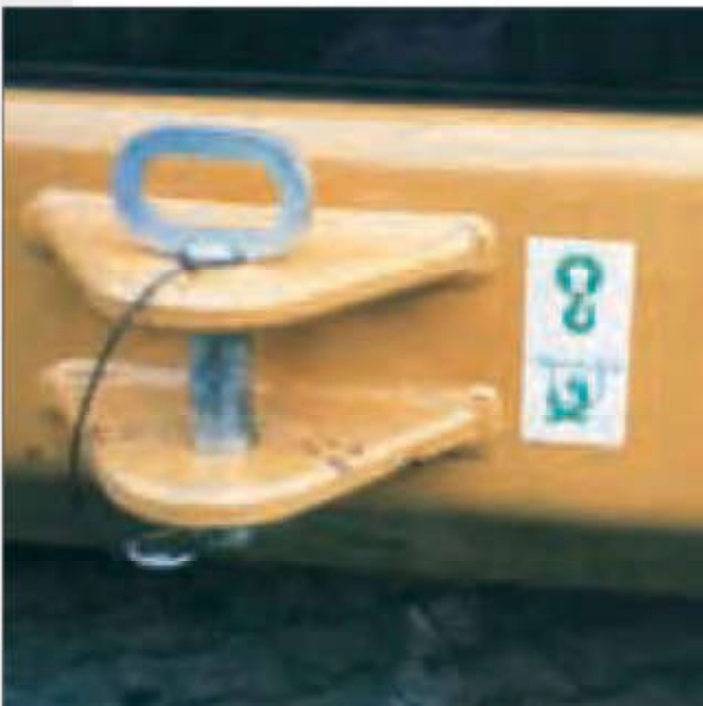
Gekennzeichneter Hebe- und Zurrpunkt an der Kupplung eines Radladers
