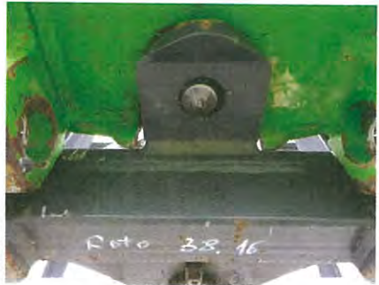
■ Abb. 7.7 Hydraulische Verriegelung zur Sicherung des Anbaugeräts
