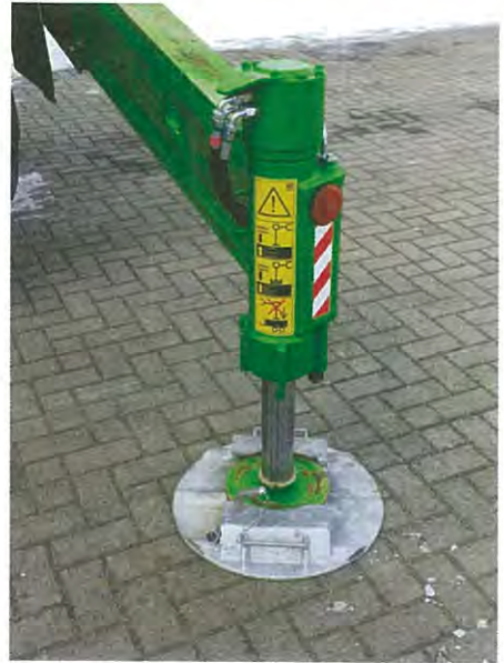
■ Abb. 6.1 Richtiges Abstützen ist enorm wichtig
