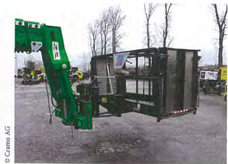
■ Abb. 7.4 Arbeitsbühne zum Transport von Personen
