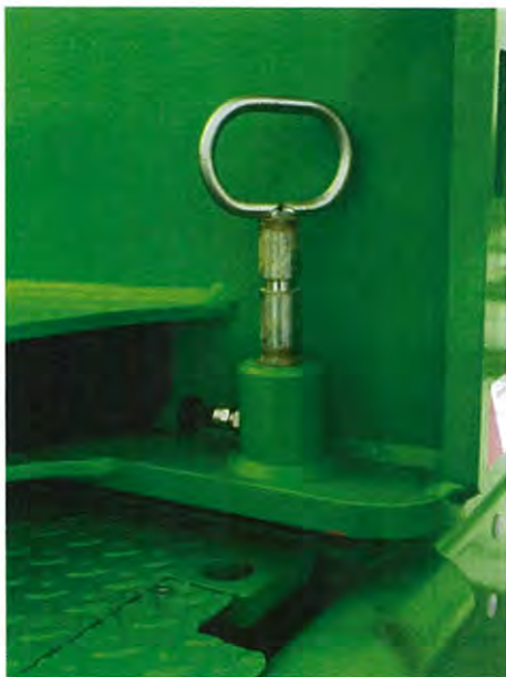
■ Abb. 8.9 Verriegelung des Oberwagens für die Straßenfahrt
