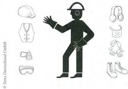
■ Abb. 8.3 Persönliche Schutzausrüstung
