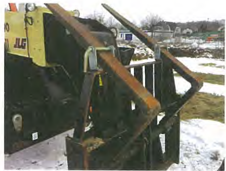
Abb. 7.1 Sicherung der Gabelzinken für die Straßenfahrten
