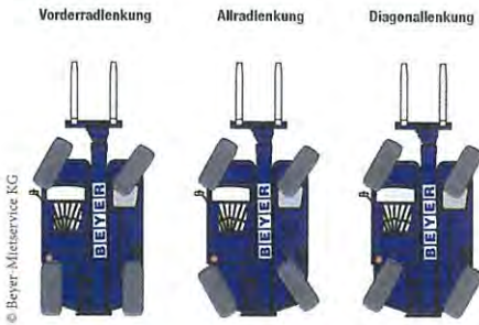
■ Abb. 5.14 Lenkungsarten: Vorderradlenkung, Allradlenkung, Hundegang (Diagonallenkung)
