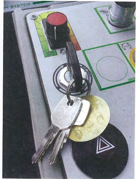
■ Abb. 8.24 Arbeitsende: Zündschlüssel abziehen!
