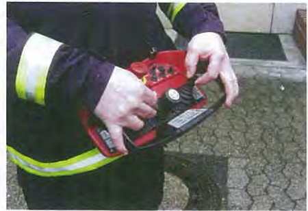
■ Abb. 5.11 Arbeiten mit einer Funkfernsteuerung
