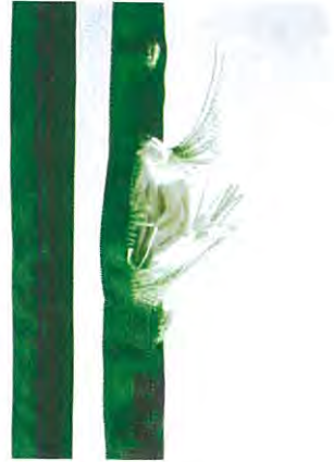
■ Abb. 8.20 Ablegereifes Hebeband
