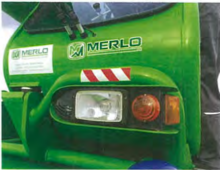
■ Abb. 8.10 Lichttechnische Einrichtung für den öffentlichen Straßenverkehr
